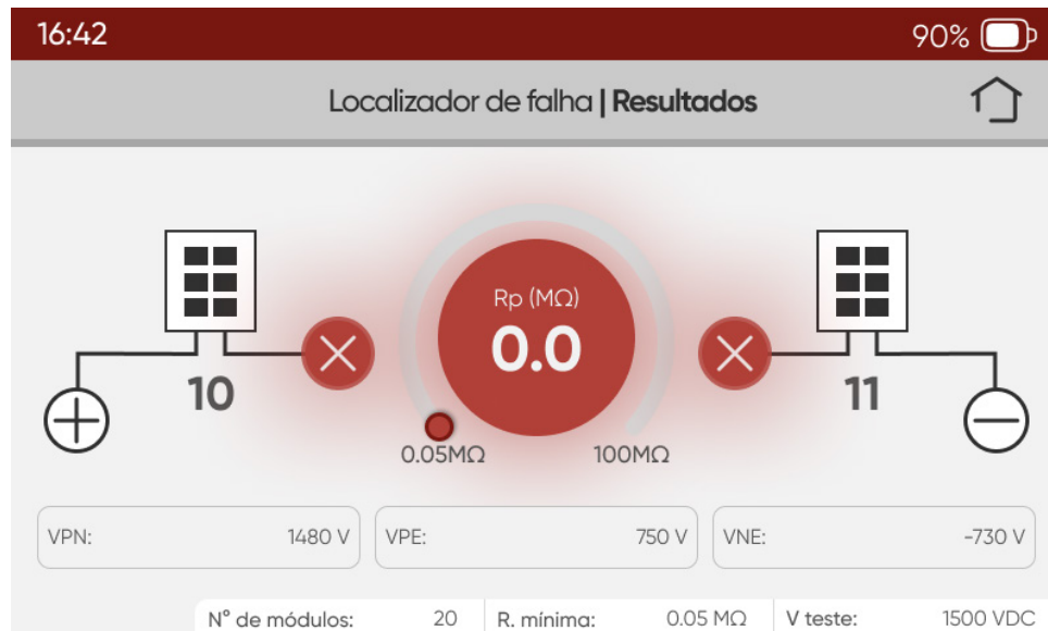
Figura 36: Falha Entre Módulos Centrais
