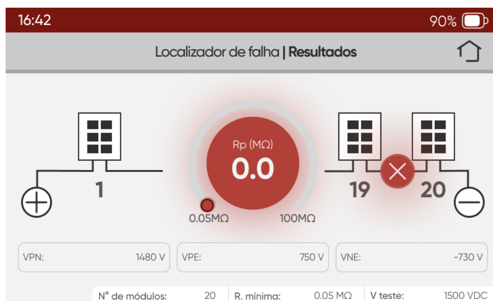
Figura 35: Falha na Posição Entre o Penúltimo e o Último Módulo
