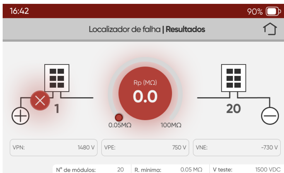
Figura 32: Falha na Posição Antes do Primeiro Módulo
