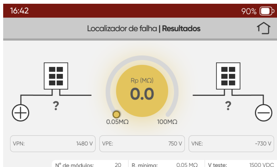
Figura 37: Falha na Posição Entre o Penúltimo e o Último Módulo
