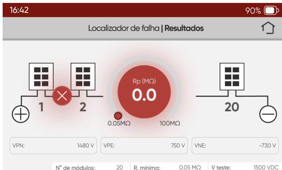
Figura 34: Falha Entre o 1 e 2 Módulo
