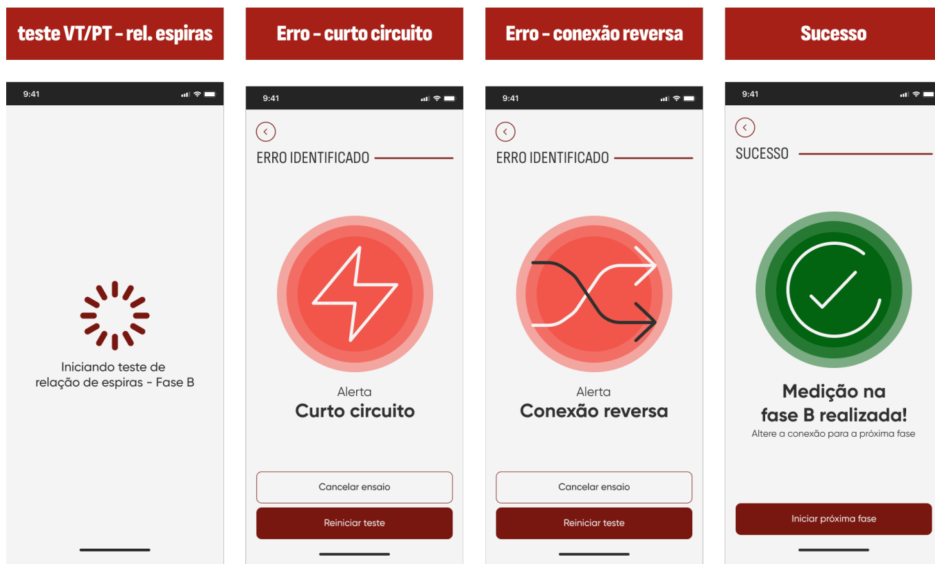
Figura 69: Fluxo 4 - Ensaio VT/PT Continuidade + Relação de Espiras Trifásico Mobile (FASE B)
