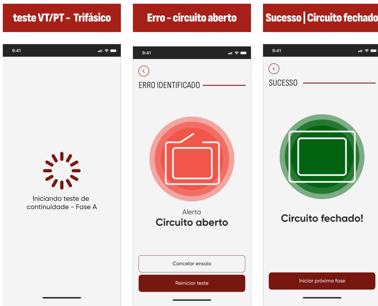
Figura 67: Fluxo 2 - Ensaio VT/PT Continuidade + Relação de Espiras Trifásico Mobile (FASE A)
