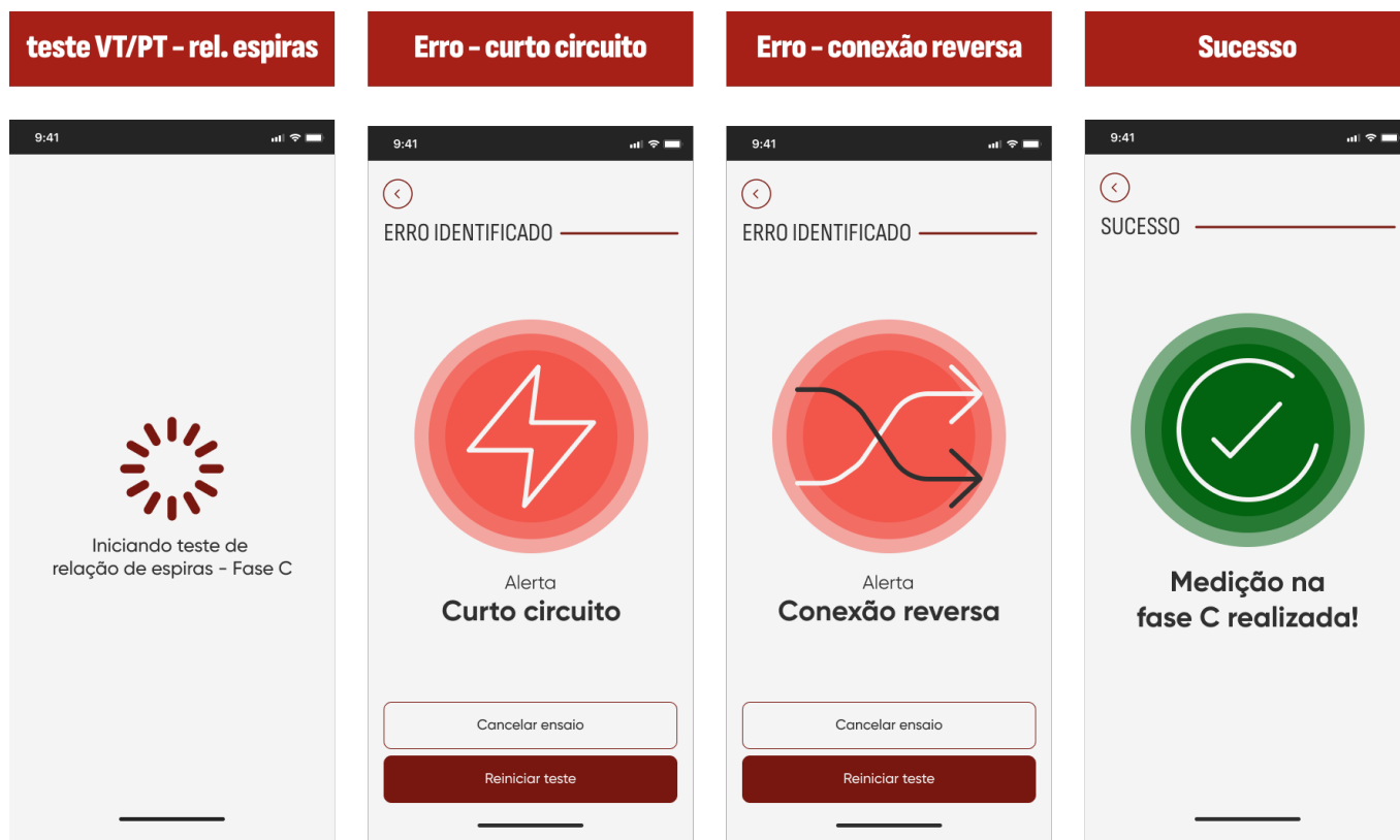
Figura 78: Fluxo 4 - Ensaio VT/PT Relação de Espiras Trifásico Mobile (FASE C)
