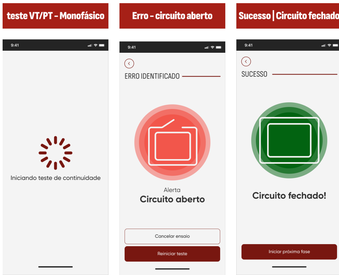
Figura 63: Fluxo 2 - Ensaio VT/PT Continuidade + Relação de Espiras Monofásico Mobile
