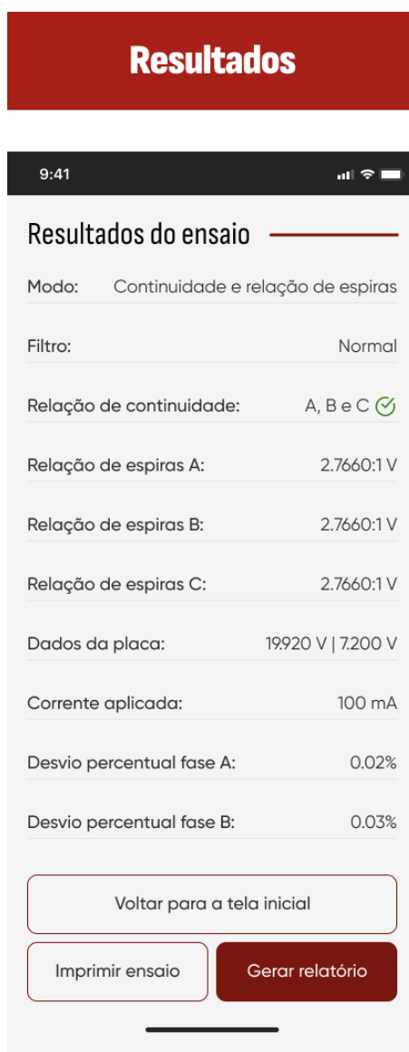
Figura 71: Fluxo 6 - Ensaio VT/PT Continuidade + Relação de Espiras Trifásico Mobile (FASE C)
