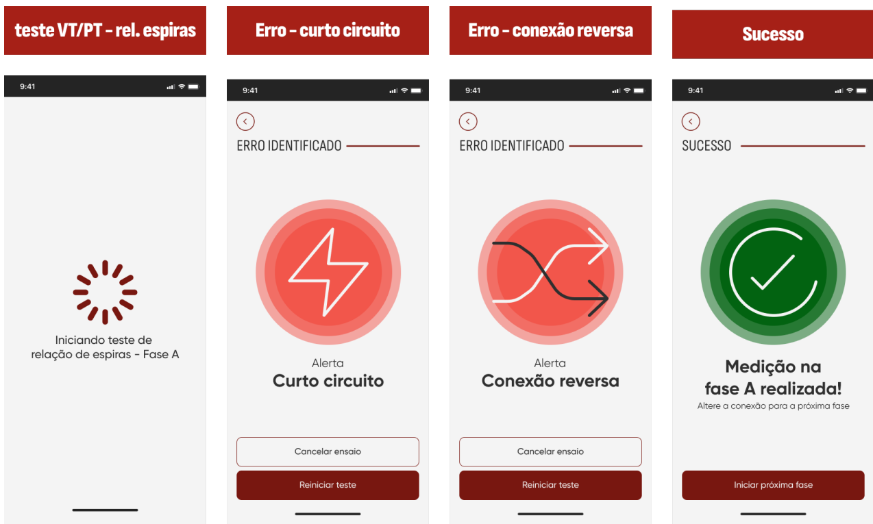
Figura 76: Fluxo 2 - Ensaio VT/PT Relação de Espiras Trifásico Mobile (FASE A)
