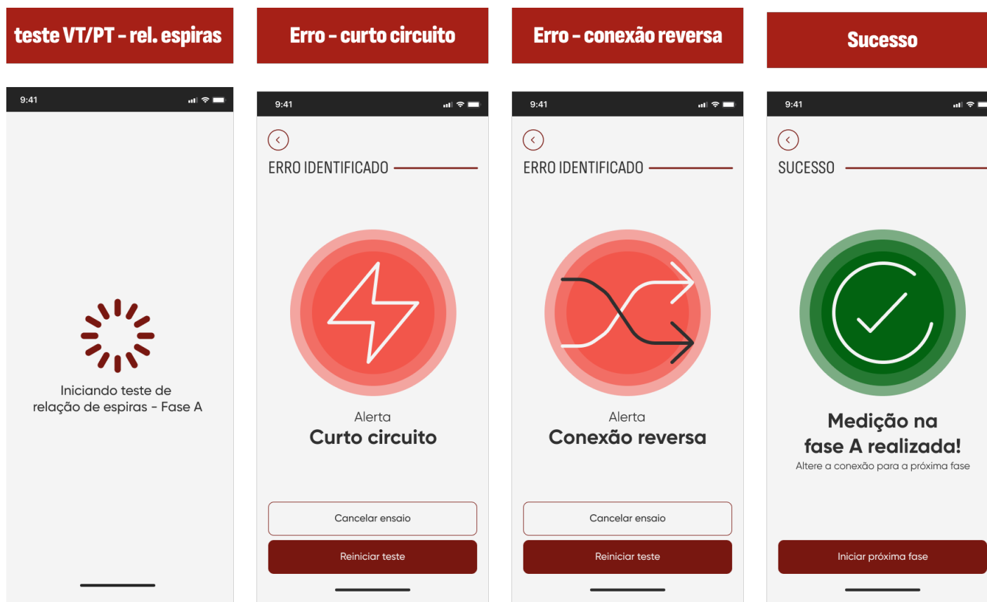
Figura 68: Fluxo 3 - Ensaio VT/PT Continuidade + Relação de Espiras Trifásico Mobile (FASE A)
