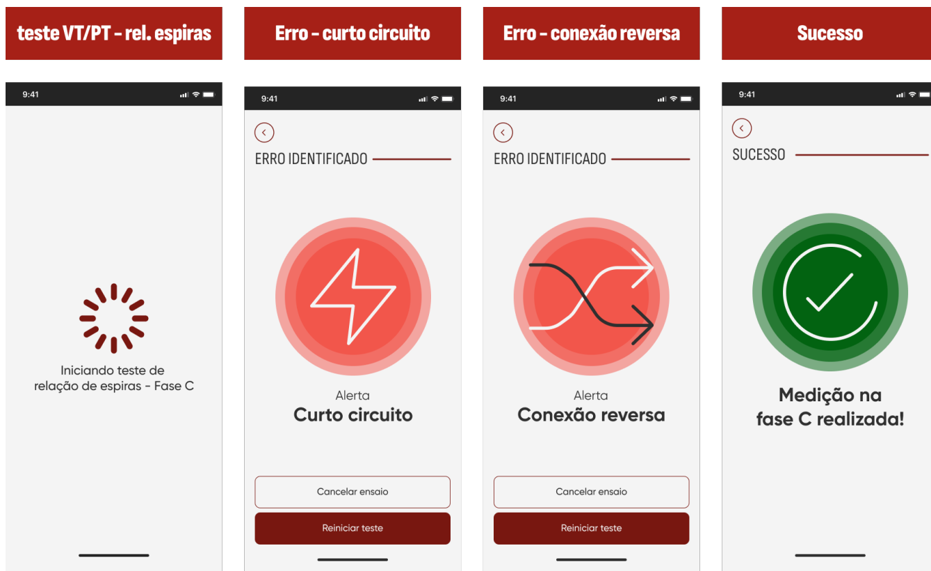
Figura 70: Fluxo 5 - Ensaio VT/PT Continuidade + Relação de Espiras Trifásico Mobile (FASE C)
